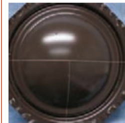
Фото образца №4 Защитное покрытие Pural RWS. 14000 часов испытаний: защитный материал сохранен полностью
