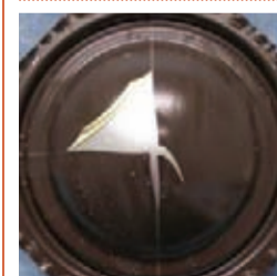
Фото образца №5 Пришел в негодность после 7200 часов испытаний
