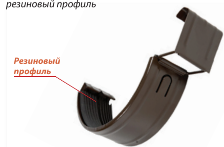
Фото 2 Зазоры между желобами должны герметизироваться соединителем желоба, от протекания воды через который защищает резиновый профиль
