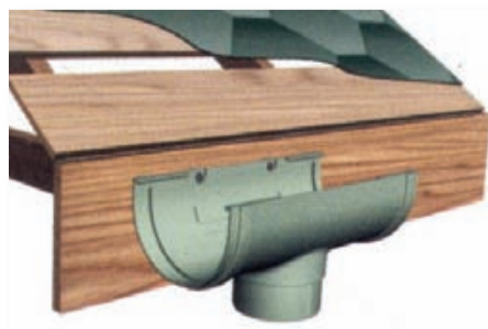
Фото 1 Предлагаемое крепление для любого инженера, знакомого с нашими зимами, выглядит откровенно комично
