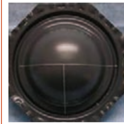
Фото контрольного образца Исходный вид. Каждый контрольный образец подвергается сознательной деформации 67%, а на защитную поверхность наносятся царапины
