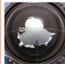
Фото образца №2 Уже после 4500 часов испытаний пришел в негодность
